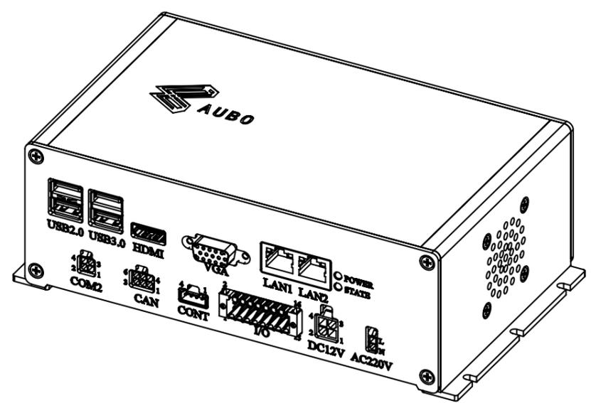
注：转接板可拆卸，控制盒底部安装。
